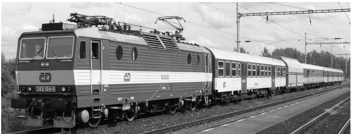
Obr. 5 Souprava zkušebního vlaku s nákladním vozem Talns a měřicím vozem VÚKV doplněná o 3 brzdicí vozy
