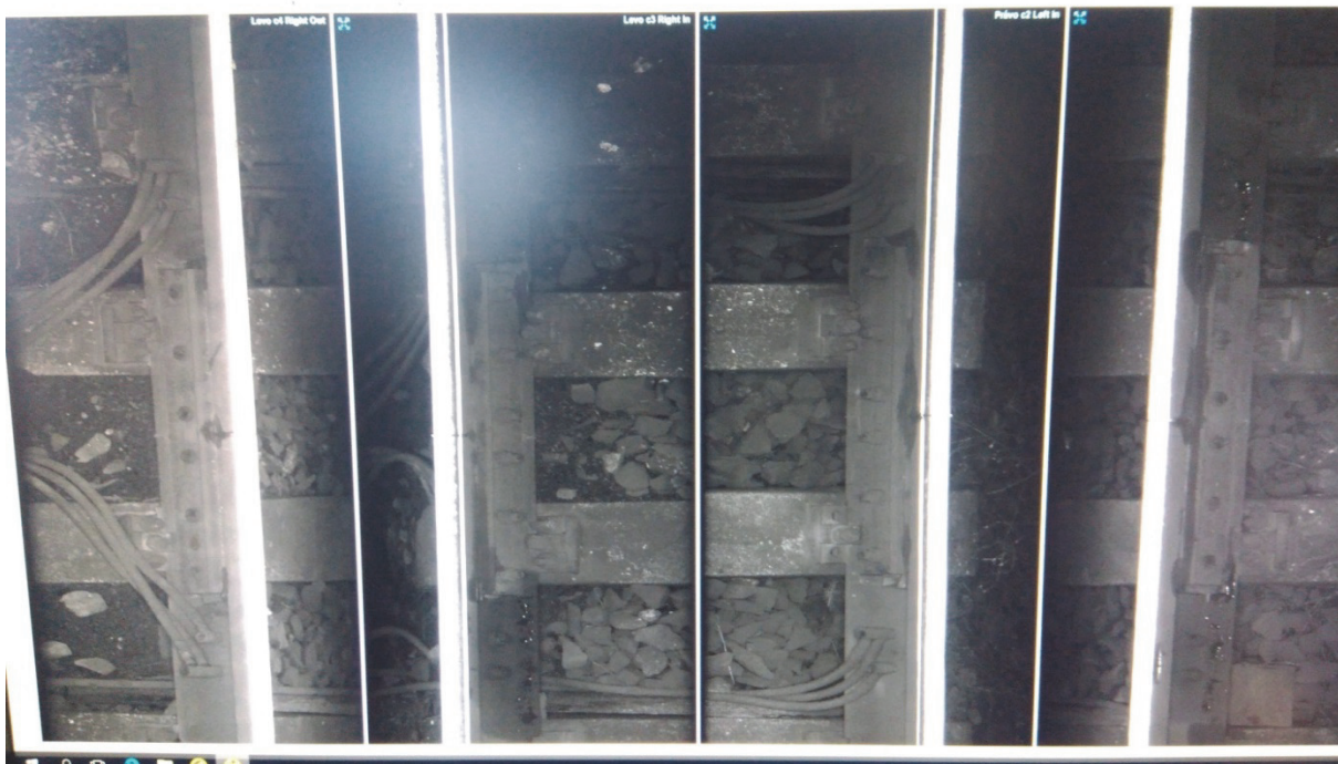
Obr. 3 - Příklad výstupu systému pro vizuální kontrolu kolejnic
