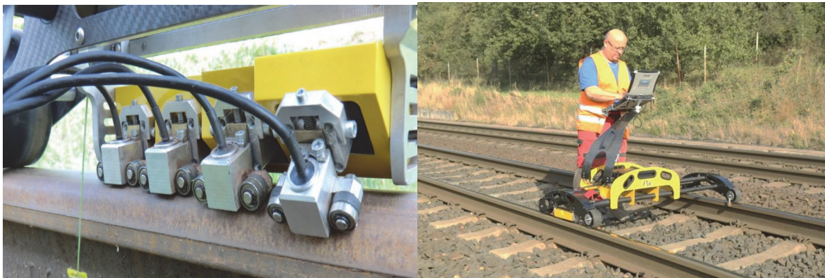
Obr. 5 - Měřicí vozík ET – umístění měřicích sond – měření v koleji
