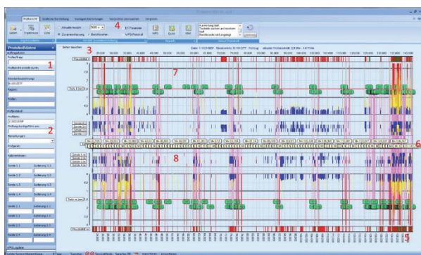
Obr. 4 - Měřicí systém vířivých proudů – grafický výstup – instalace na měřicím podvozku
