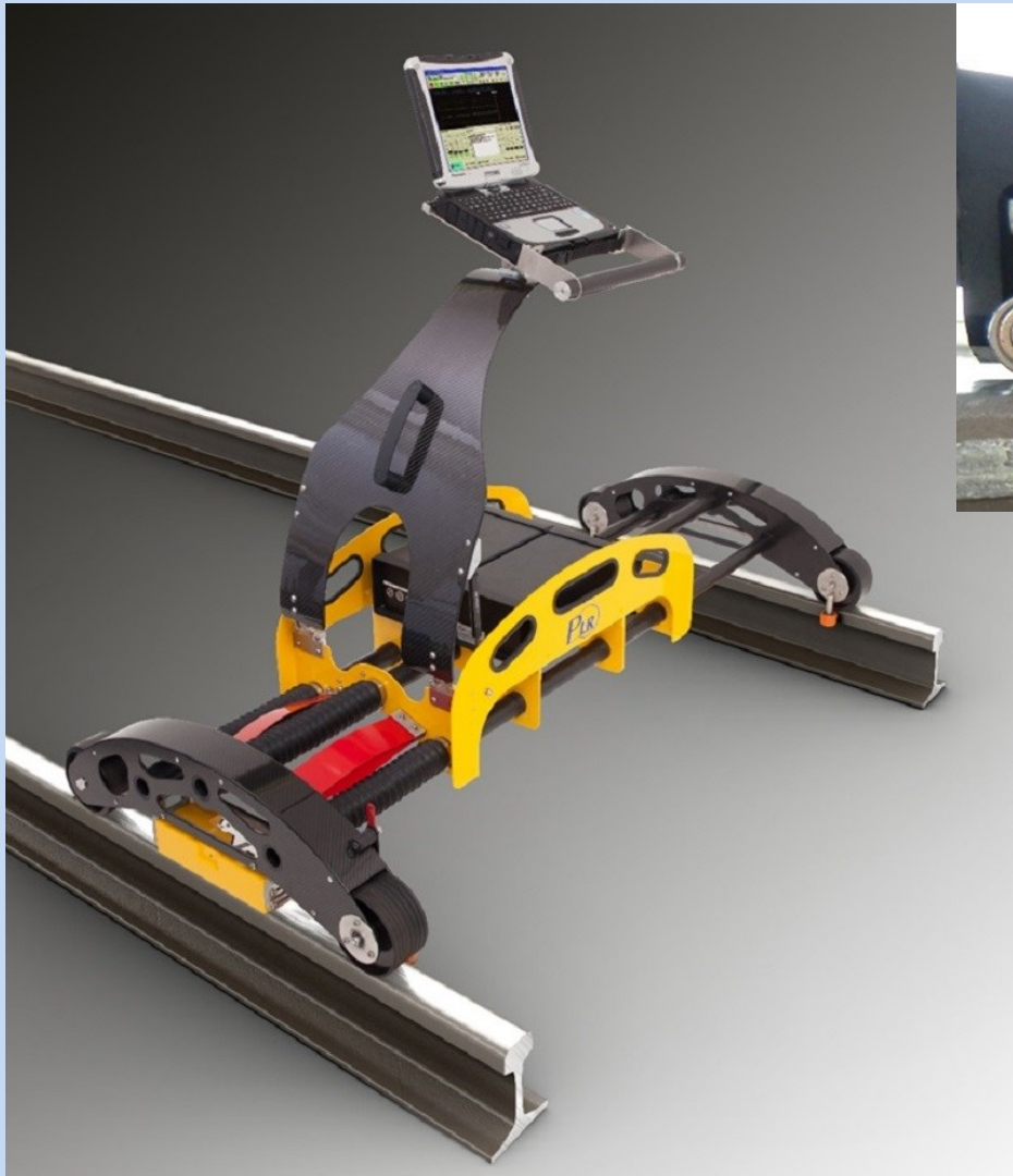
Měřicí vozík pro zjišťování povrchových vad kolejnic
