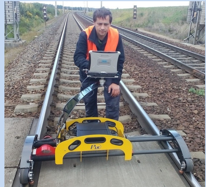
Měřicí vozík pro zjišťování povrchových vad kolejnic
