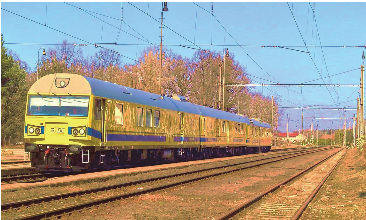
Obr. 1 - Diagnostická jednotka DJ NDT
