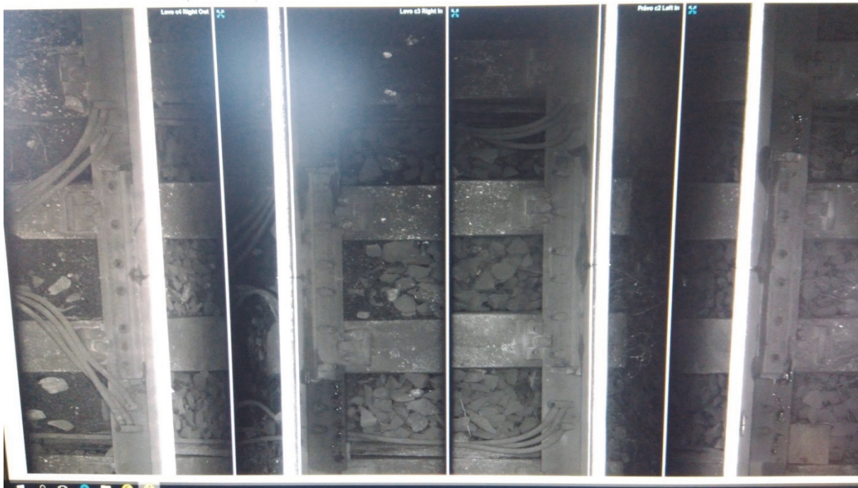
Obr. 3 - Příklad výstupu systému pro vizuální kontrolu kolejnic
