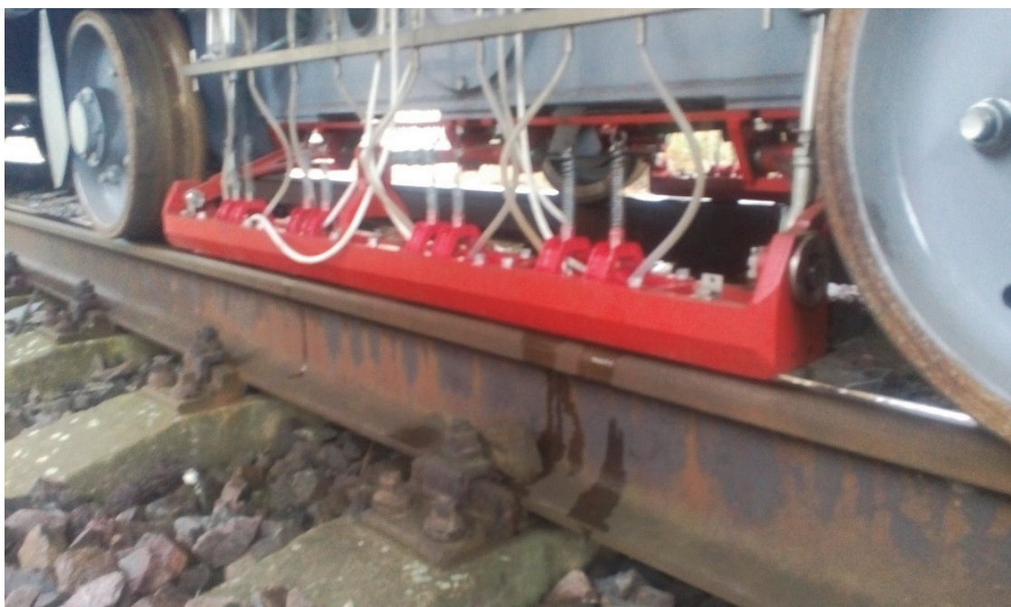
Obr. 2 - Systém ultrazvukové kontroly kolejnic na měřícím podvozku jednotky DJ NDT
