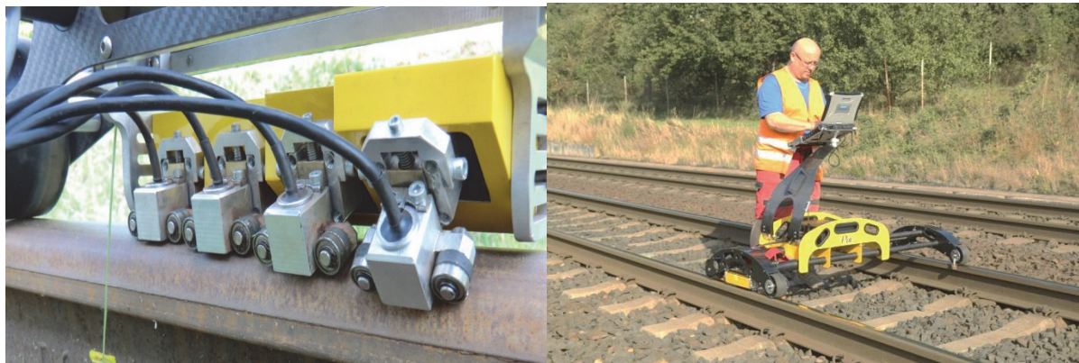
Obr. 5 - Měřicí vozík ET – umístění měřících sond – měření v koleji
