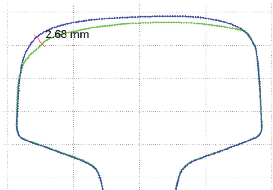
Obr. 3 - Výhybka č. 1, žst. Krasíkov: porovnání tvaru hlavy kolejnice vnějšího pásu středové části výhybky před reprofilací (horní čára) a po reprofilaci (dolní čára)
