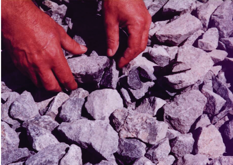
Obr. 1 Zrna kameniva rozlámaná po přejezdu těžkého válce
