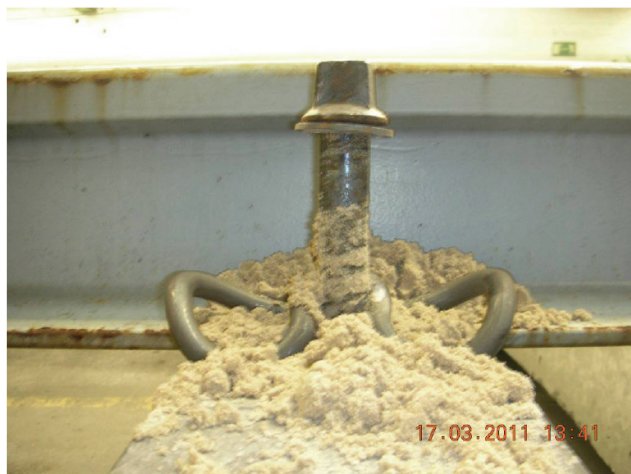
Obr. 6 Zkouška montáže uzlu upevnění znečištěného pískem
