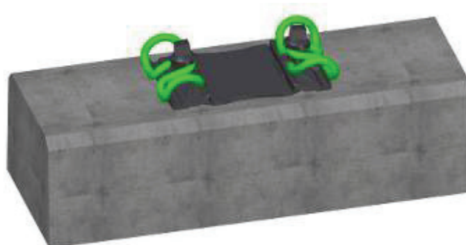
Obr. 3 Bezpodkladnicové upevnění na výhybkovém pražci
