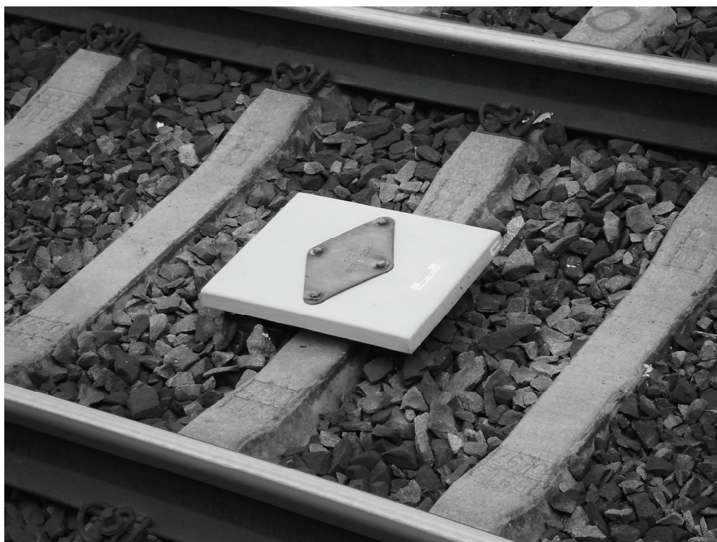
Obr. 1. Eurobalíza v provedení použitým na pilotním projektu ETCS
