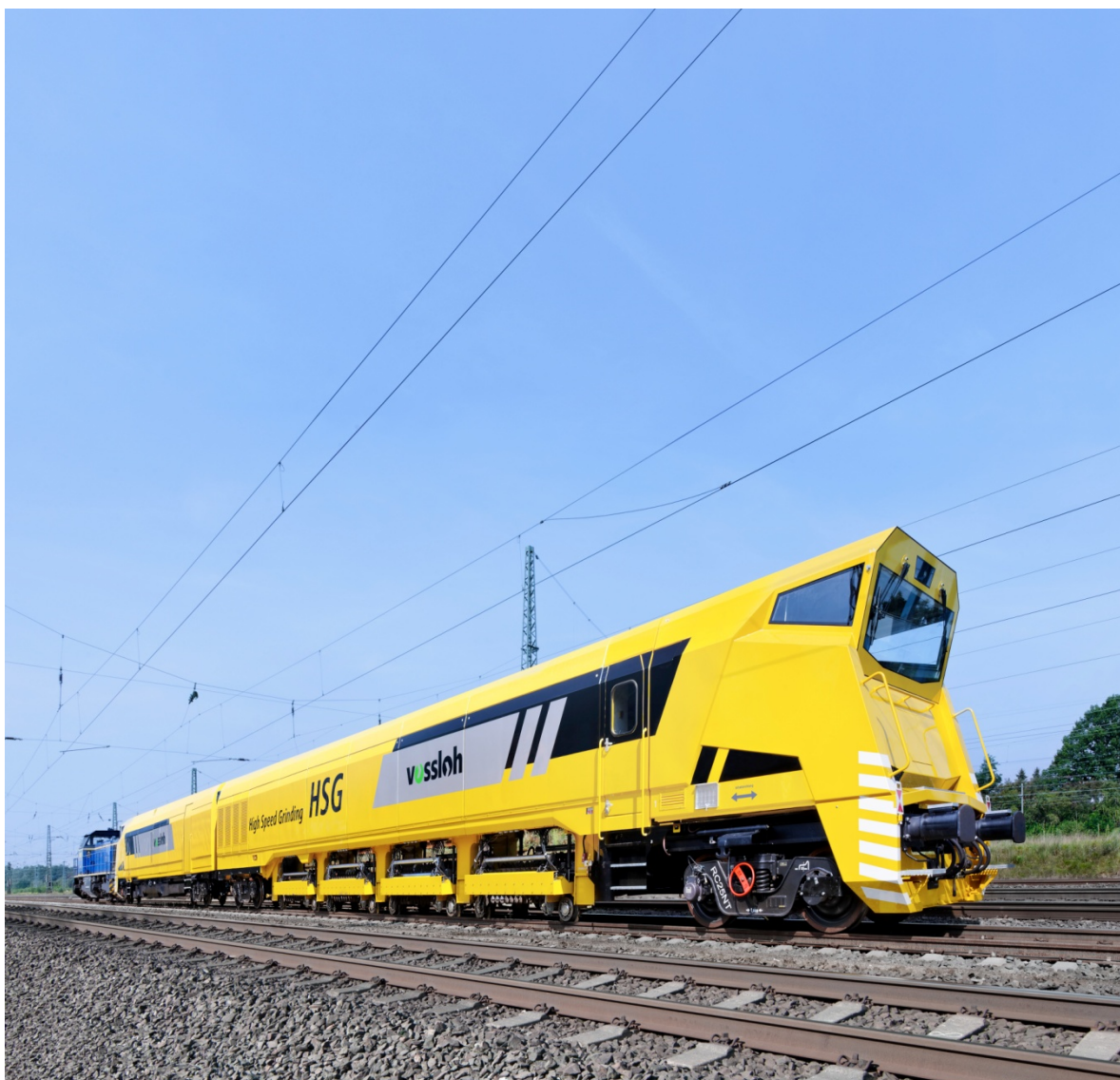
Obr. 3: Vysokorychlostní brousící vlak HSG-2
