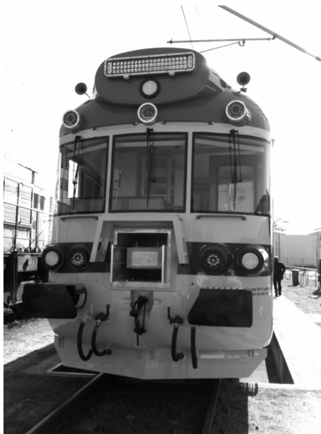
Obrázek 6: Příprava a osazování měřicích systémů na čelo měřicího vozu PPT
