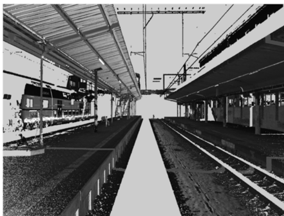
Obrázek 5: Příklad generovaného obrazu systémem MMS
