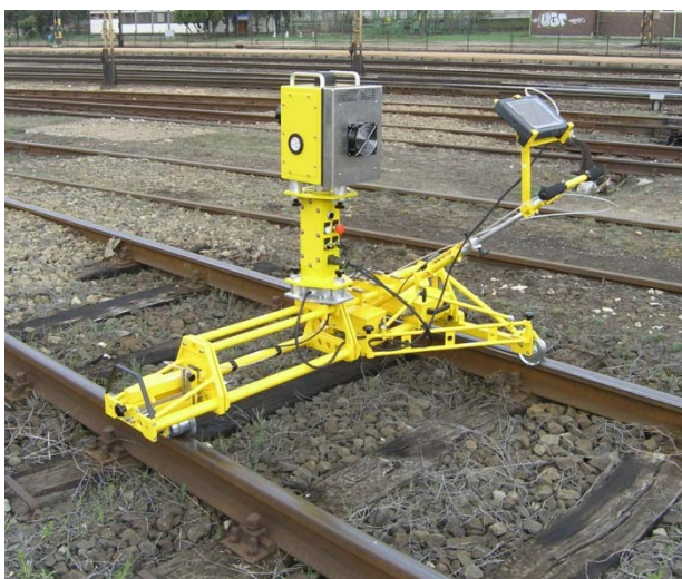
Obr. 3: Ruční měřicí zařízení prostorové průchodnosti tratí
