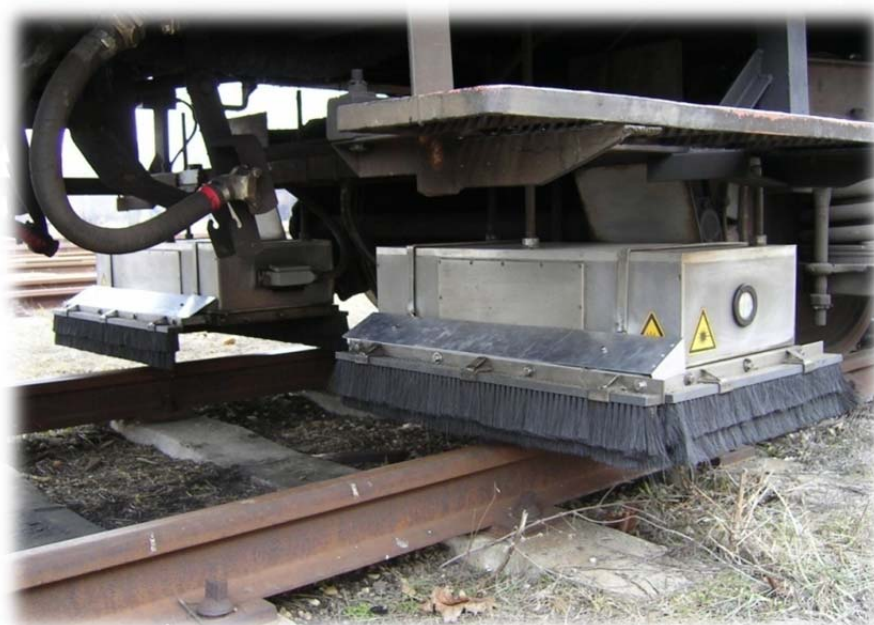
Obr. 8: Zařízení pro zjištění profilů kolejnic na SDS
