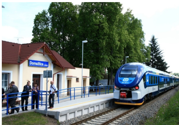
Obrázek 15: Nástupiště s hranou H 130 – SŽDC - Domažlice
