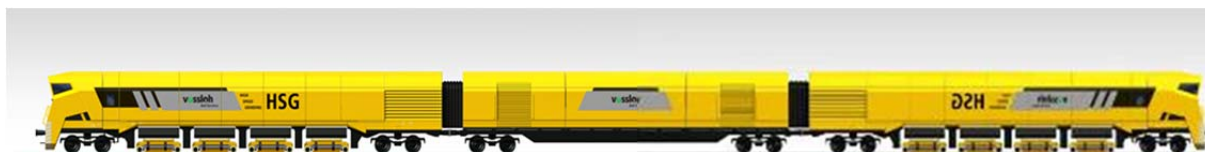
Obr. 4: Stroj HSG-2 se dvěma brousícími vozy
