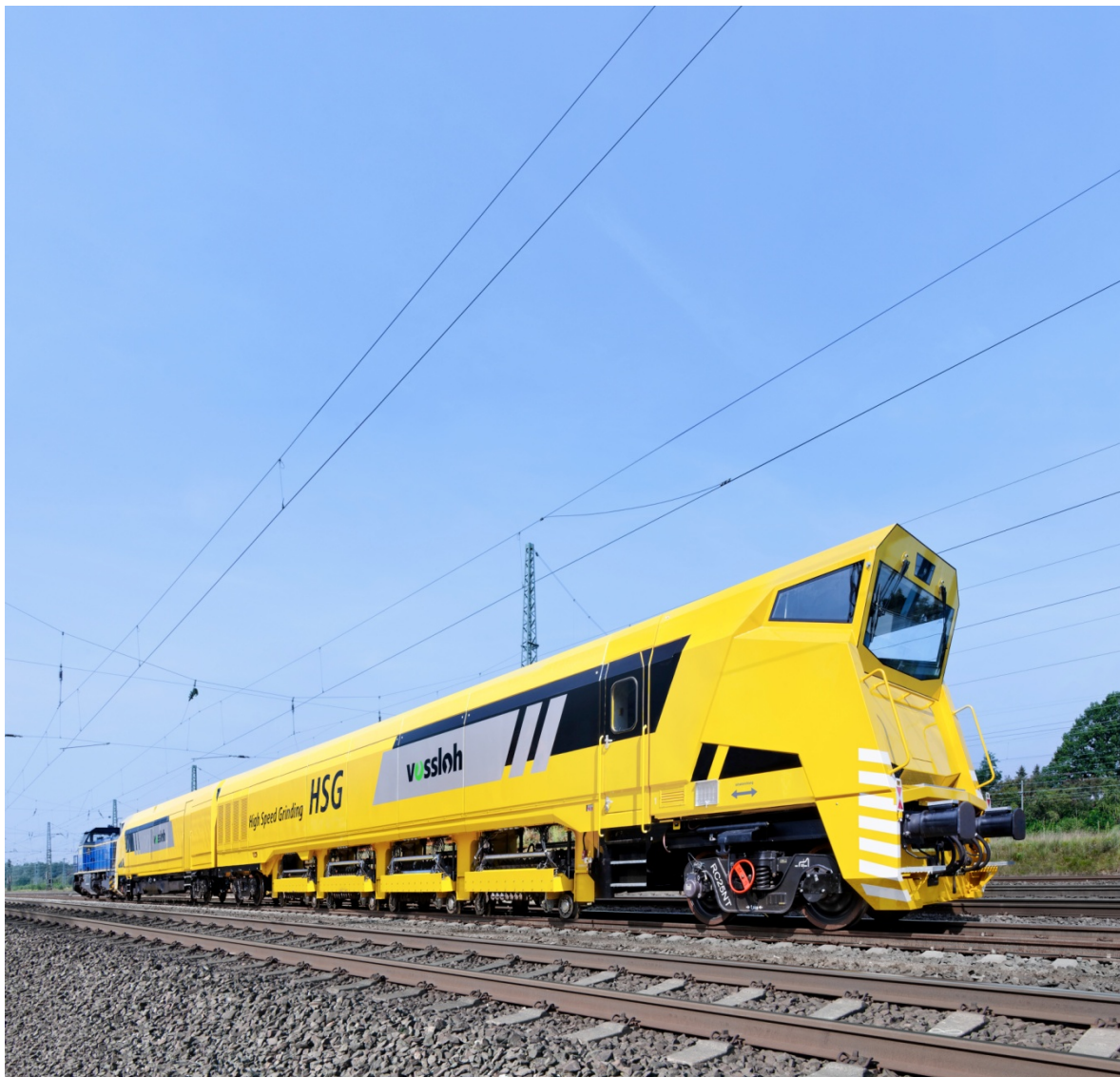
Obr. 3: Vysokorychlostní brousící vlak HSG-2
