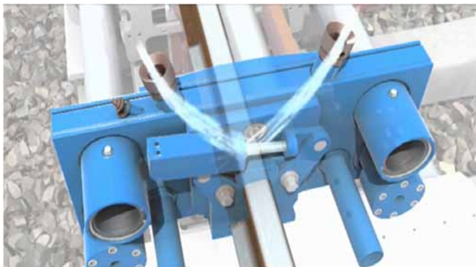
Obr. 5: Integrovaná jednotka pro chlazení a ořez svaru [1]
