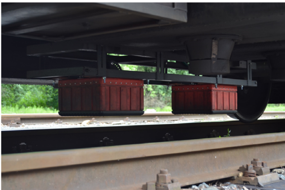
Obr. 2: Umístění antén na diagnostické soupravě NDT
