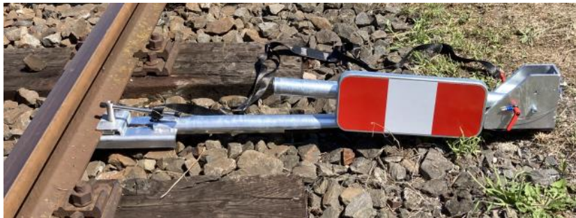
Obr. 2 Složená konstrukce upevněná ke koleji
